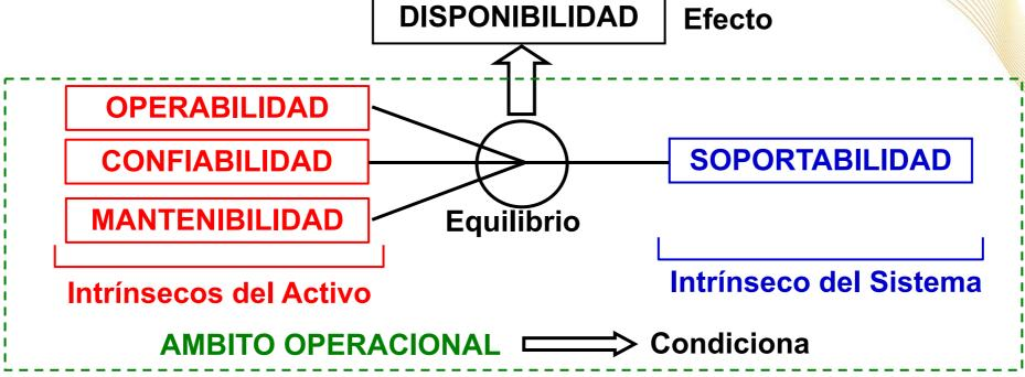
La Ingeniería de Sistemas orienta al diseño y la fabricación de la confiabilidad y la mantenibilidad, pero la disponibilidad es función de la confiabilidad y mantenibilidad inherentes, así como de la soportabilidad del sistema.
